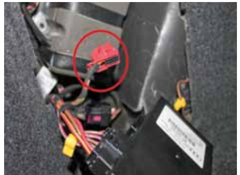
Roten Stecker durch Drücken des Rasthakens aus dem Steuergerät ziehen.
