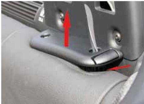
Um die Führungsblende zu entfernen müssen Sie jeweils zwei Schnapphaken im Inneren der Führungslöcher lösen. Dies geht am einfachsten mit einem gebogenen Gegenstand (z.B. Nagelschere) oder einem kleinen Flachsraubendreher. Ziehen Sie kontinuierlich die Blende nach oben während Sie die Schnapphaken in Richtung Lochmitte drücken. Lösen Sie abwechselnd beide Seiten und ziehen dann die gesamte Führungsblende nach oben.
