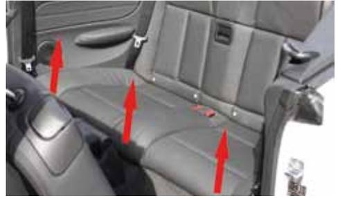
Die Lehne wird durch zwei Muttern an der Unterkante fixiert. Lösen Sie beide Muttern mit einer Schraubnuss oder einem Gabelschlüssel. Wenn Sie die Unterkante der Lehne leicht nach vorne ziehen, kann die gesamte Lehne nach oben hin abgehoben werden.
